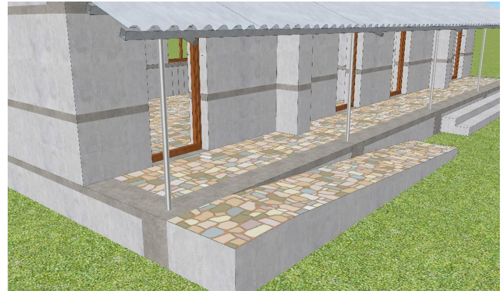
चित्र नं. ६३: बरन्डा र कक्षाकोठाहरूमा माटो र पोलिथिन बिछ्याउने यसपछि ढुङ्गाहरू छापेर सिमेन्ट मसला लगाई जोर्नीहरू पुर्ने
