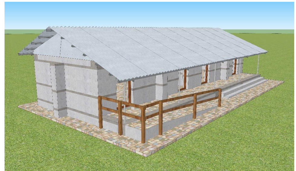
चित्र नं. ६४: जग्गामा पानी नछिर्नेको लागि लाई जाँचो चारैतिर ढुङ्गाको सेलिङ्ग गरी ढुङ्गाको जोर्नीहरूमा माटो वा सिमेन्ट मसला भरी ४५० - ६०० मि.मि. चौडा पेटी बनाउने
