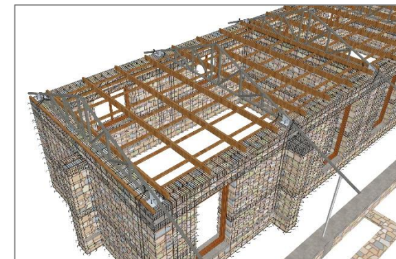
चित्र नं. ५४: फल्स सिलिङको बीमहरू राखेपछि ५० x ५०मि.मि. को काठको लिस्टी ६०० मि.मि.को दुरीमा राख्नुपर्छ
