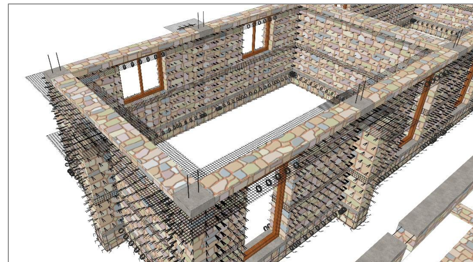
चित्र नं. ३६: लिन्टेल बन्धनको लागि तारजाली राखेपछि यसमाथी ढुङ्गाको गारो लगाइ ट्रसको कुनामा कङ्क्रिट गर्नुपर्छ । मुल गारोमा व्याण्डको जाली ठाडो बनाएपछिमात्र टेवा गारोको ढुङ्गा राख्ने
