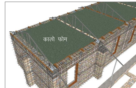
चित्र नं. ५६: कालो फोम राखेपछि चित्रा (मान्द्रो) राख्नुपर्छ
