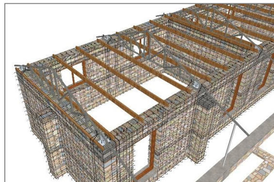
चित्र नं. ५३: छाना राख्नुभन्दा पहिले फल्स सिलिङ बनाउनु राम्रो हुन्छ र फल्स सिलिङको बीम भने राख्नुपर्छ
