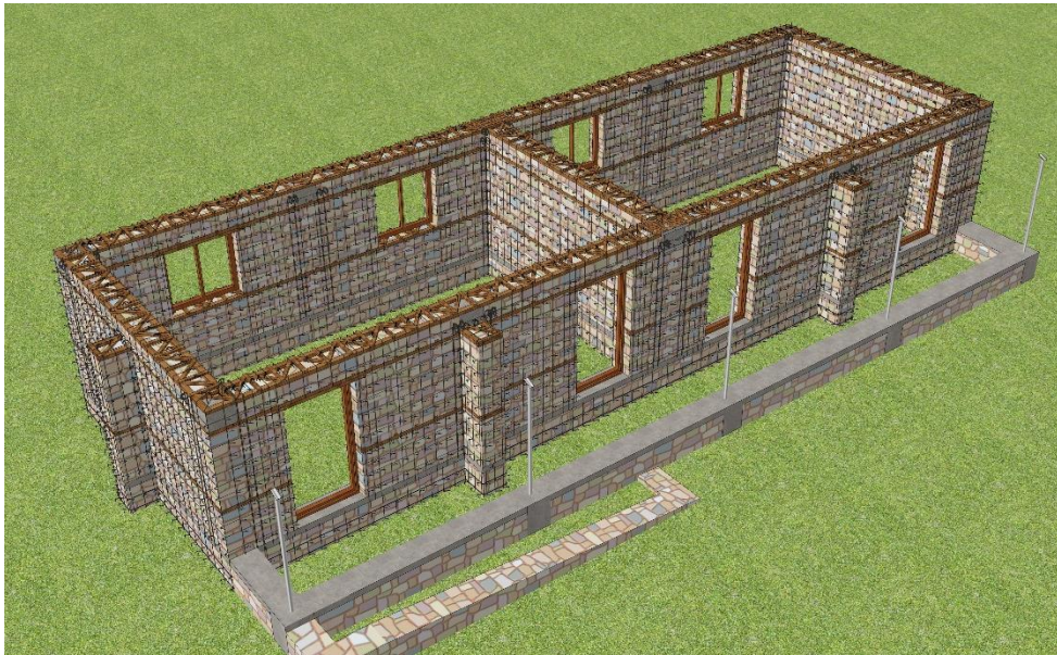
चित्र नं. ८४: ट्रसहरू राख्नुअघि बरन्डामा रहने फलामे पाईपको पोष्ट तयार गर्नुपर्छ
