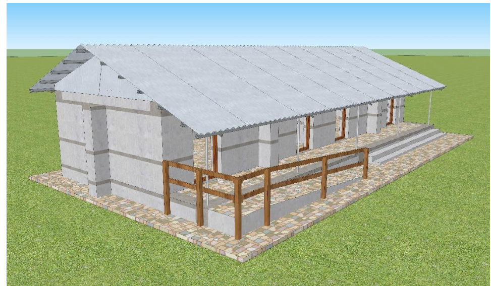
चित्र नं. ५७: जगमा पानी नछिर्नको लागि गारोलाई चारैतिर ढुङ्गाको सेलिङ गरी ढुङ्गाको जोर्नीहरूमा माटो वा सिमेन्ट मसला भरी ४५० - ६०० मि.मि. चौडा पेटी बनाउने
