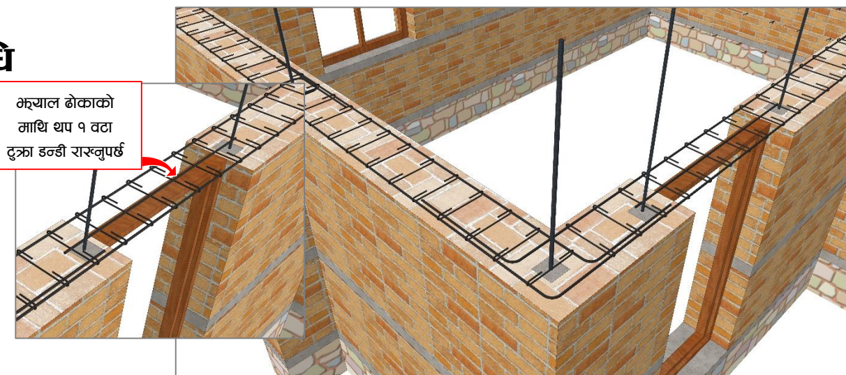
चित्र नं. ३१: लिन्टेल बन्धनमा भ्याल ढोकामाथि थप १-१ वटा डन्डी तेर्सो गरी बीचमा राख्नुपर्छ
