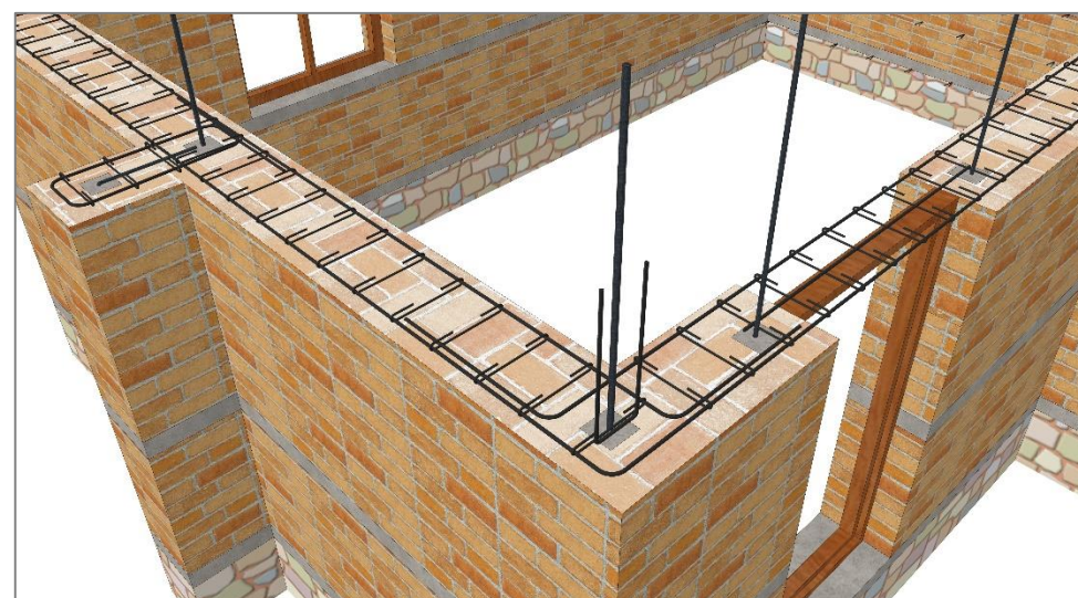
चित्र नं. ३२: ट्रस बस्ने ठाउँमा U आकारको एङ्कर बोल्ट लिन्टेलको डन्डी र रिङ्गसँग बाँधेर ठड्याउनुपर्छ
