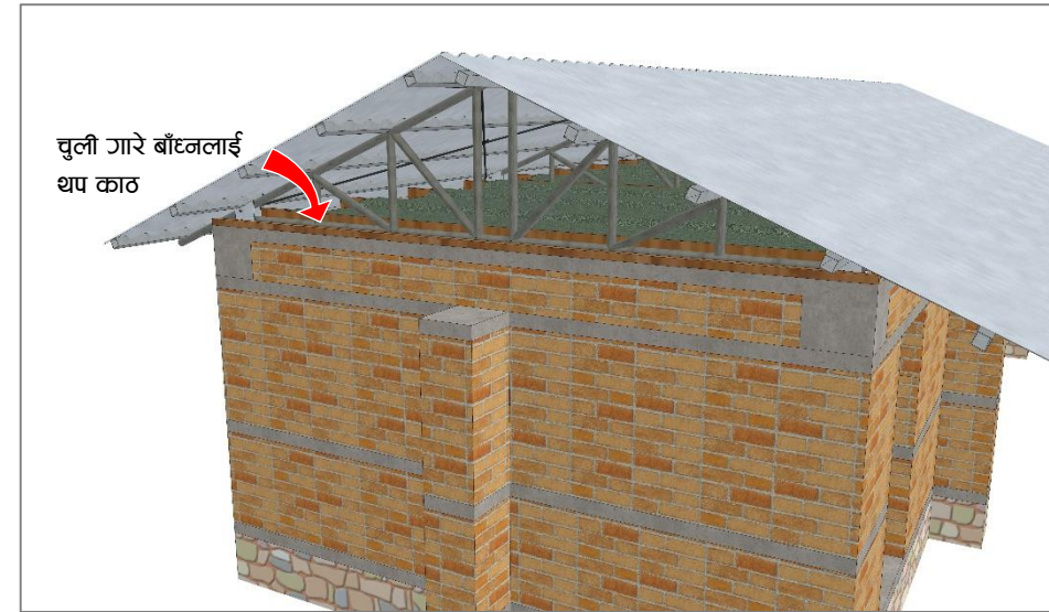
चित्र नं. ४८: तिनकुने गारोलाई बन्द गर्न ईभ्स बन्धनको बाहिरी सतहमा पर्ने गरी काठको बीम थप्ने र य बीमलाई ईभ्स बन्धनसँग राम्ररी बाँध्नुपर्छ
