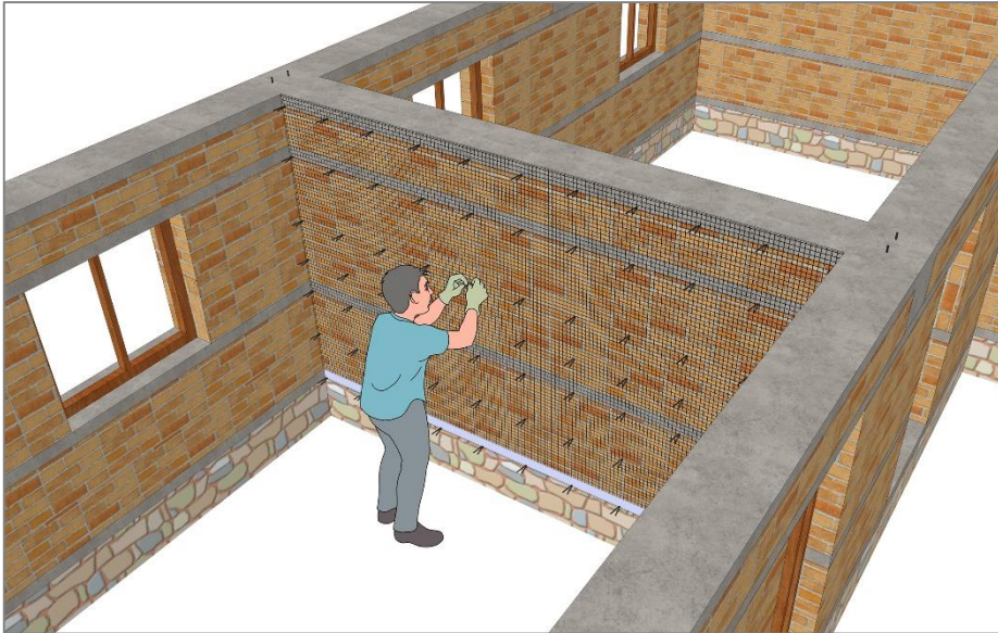
चित्र नं. ३९: दुई कोठा बीचको गारोमा राखेका दुई जिब्रेहरूलाई तार जाली राखेर कस्नुपर्छ
