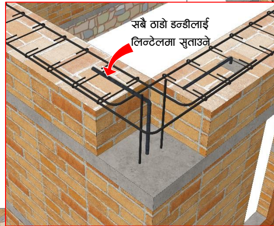
चित्र नं. ३७: U एङ्कर रहेका ठाउँहरूमा थप ढलान गर्नुपर्छ । ढलान तयार भएपछि ईभ्स बन्धनका डन्डी र रिङहरू राख्नुपर्छ
