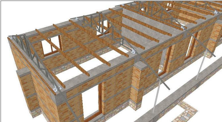
चित्र नं. ४४: फल्स सिलिङको लागि १५० x ५० मि.मि. को काठको बीमहरू १ मि.को दुरीमा राख्नुपर्छ
