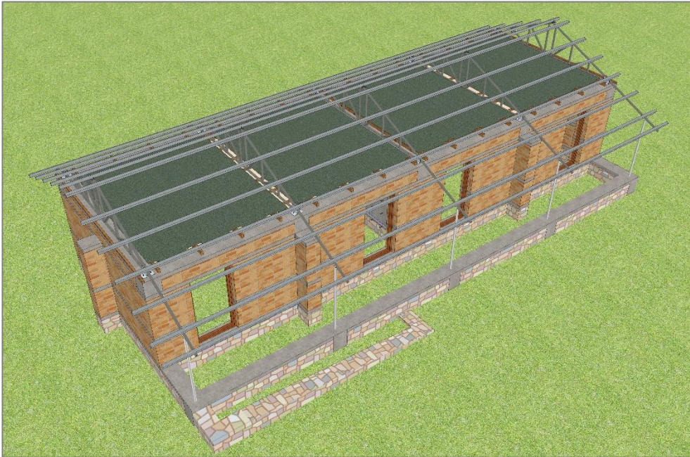
चित्र नं. ४९: ट्रसहरू राख्नुभन्दा पहिले बरन्डामा रहने फलामे पाईपको पोष्ट तयार गर्नुपर्छ
