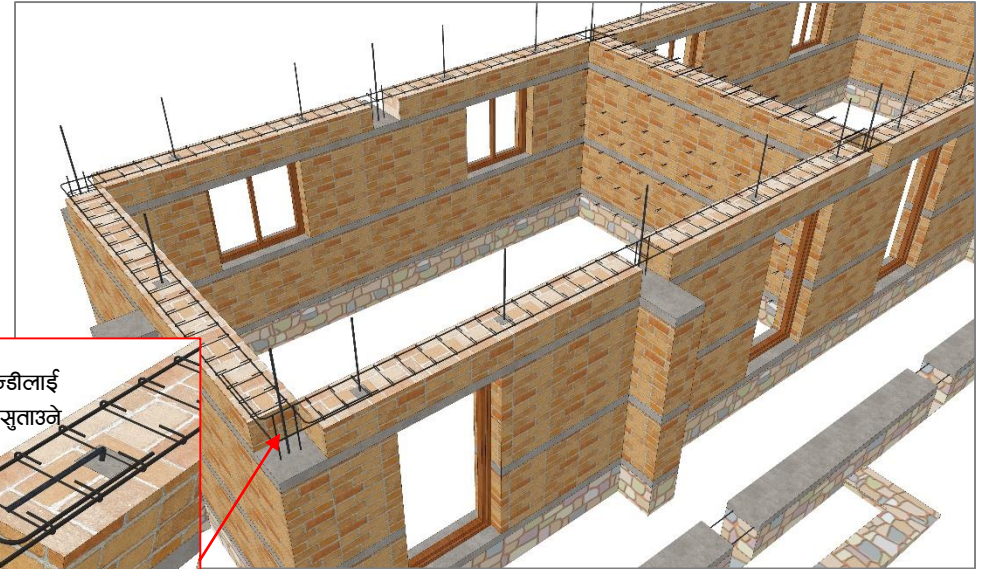
चित्र नं. ३७: U एङ्कर रहेका ठाउँहरूमा थप ढलान गर्नुपर्छ । ढलान तयार भएपछि ईभ्स बन्धनका डन्डी र रिङहरू राख्नुपर्छ
