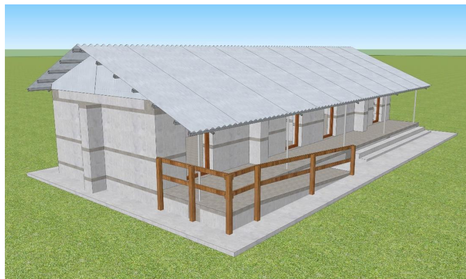
चित्र नं. ५४: जग्गामा पानी नछिर्नका लागि जारो बनाई चारैतिर ढुङ्गाको सेलिङ्ग गरी ढुङ्गाको जोर्नीहरुमा माटो वा सिमेन्ट मसला भरि ४५० - ६०० मि.मि. चौडा पेटी बनाउने
