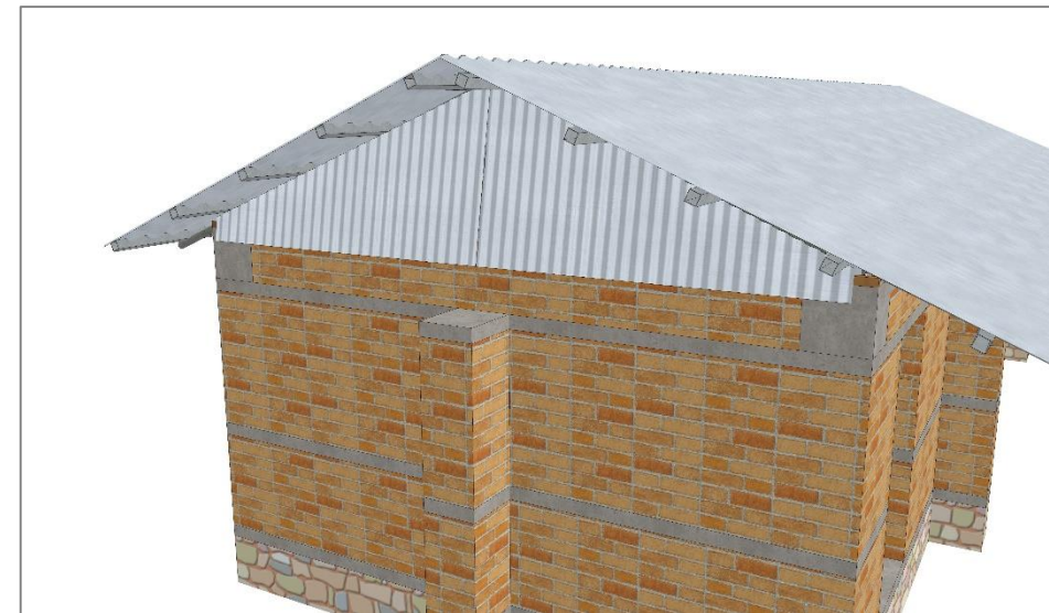
चित्र नं. ४९: जस्ता पाता माथिल्लो भागमा ट्रसको डाँडामा बाँध्ने र तल्लो पट्टि ईभ्समा गारोको बाहिरी छेउमा थपिएको काठको बीममा ठोक्ने
