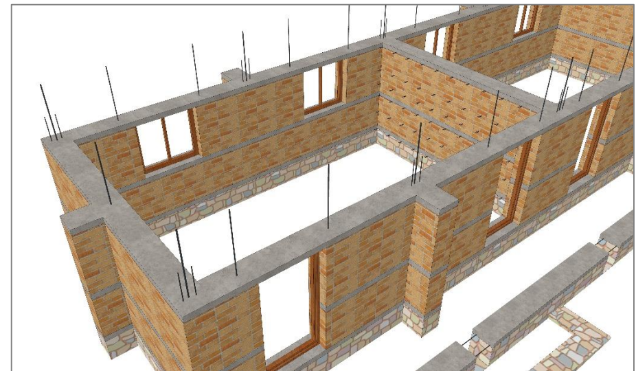
चित्र नं. ३५: टेवा गारो (बट्रेस) को डन्डीलाई सुताएर बाँधेपछि लिन्टेल बन्धनको ढलाई गर्नुपर्छ
